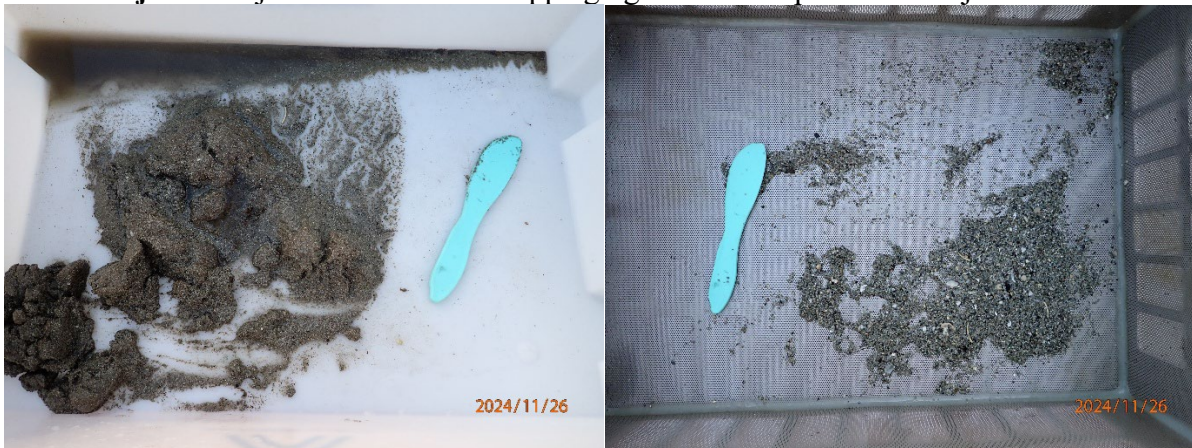
Prøvestasjon 8: Skjelsand med mørkt topplag og noko lukt i prøve med mjuk konsistens.
