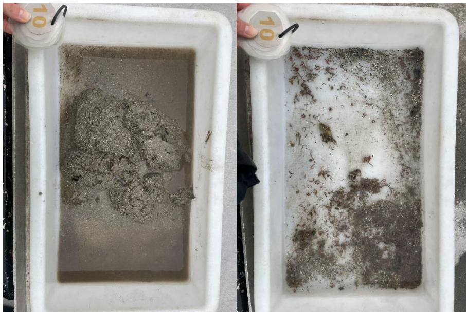
Figur 10: Bilder som viser sedimentet fra stasjon 10 før og etter siling. Sedimentet besto av silt, sand og skjellsand. Foto: Aqua Kompetanse AS.
