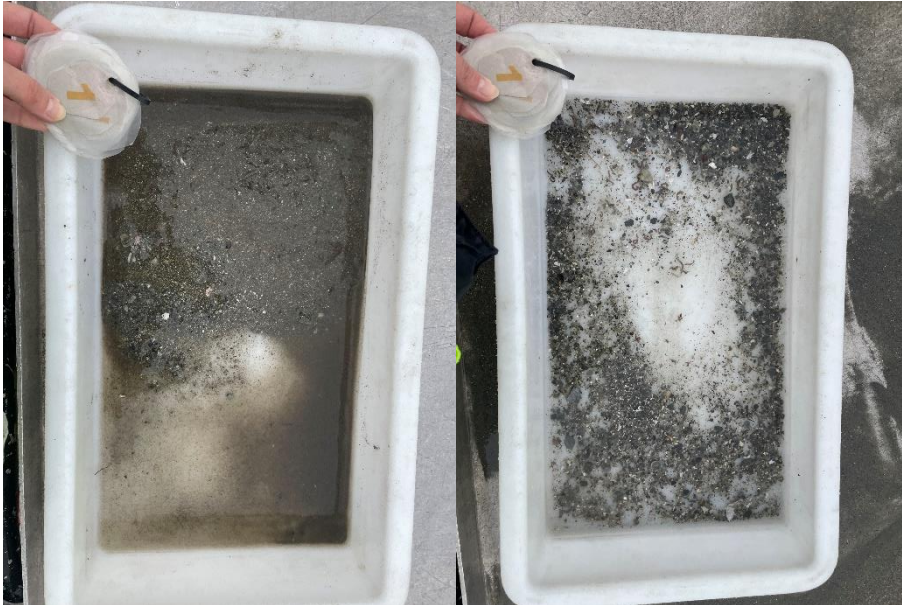
Figur 1: Bilder som viser sedimentet fra stasjon 1 før og etter siling. Sedimentet besto av sand, silt, grus og skjellsand. Foto: Aqua Kompetanse AS.
