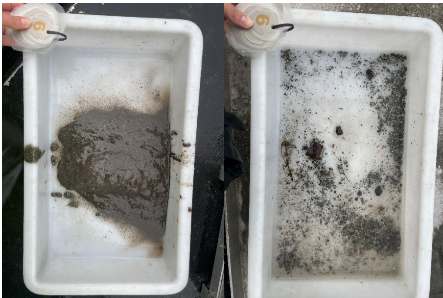
Figur 6: Bilder som viser sedimentet fra stasjon 6. Sedimentet besto av silt og grus. Foto: Aqua Kompetanse AS.
