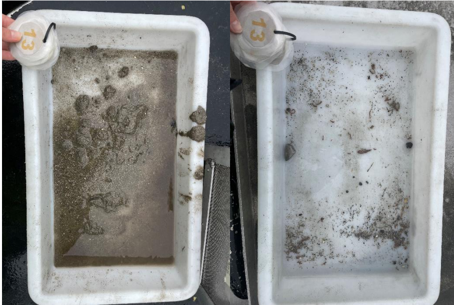
Figur 13: Bilder som viser sedimentet fra stasjon 13 før og etter siling. Sedimentet besto av sand og grus. Foto: Aqua Kompetanse AS.
