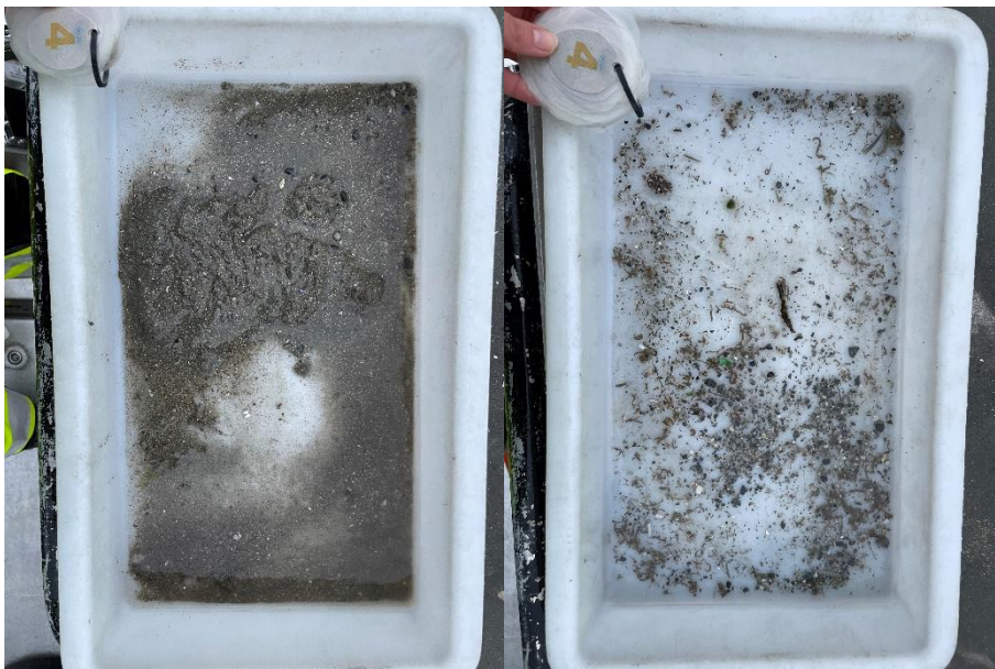
Figur 4: Bilder som viser sedimentet fra stasjon 4 før og etter siling. Sedimentet besto av sand og grus. Foto: Aqua Kompetanse AS.
