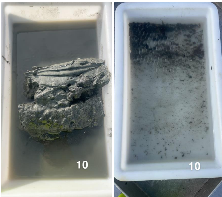
Figur 10: Bilder som viser sedimentet fra stasjon 10 før og etter siling. Sedimentet besto av leire og noe silt. Foto: Aqua Kompetanse AS.
