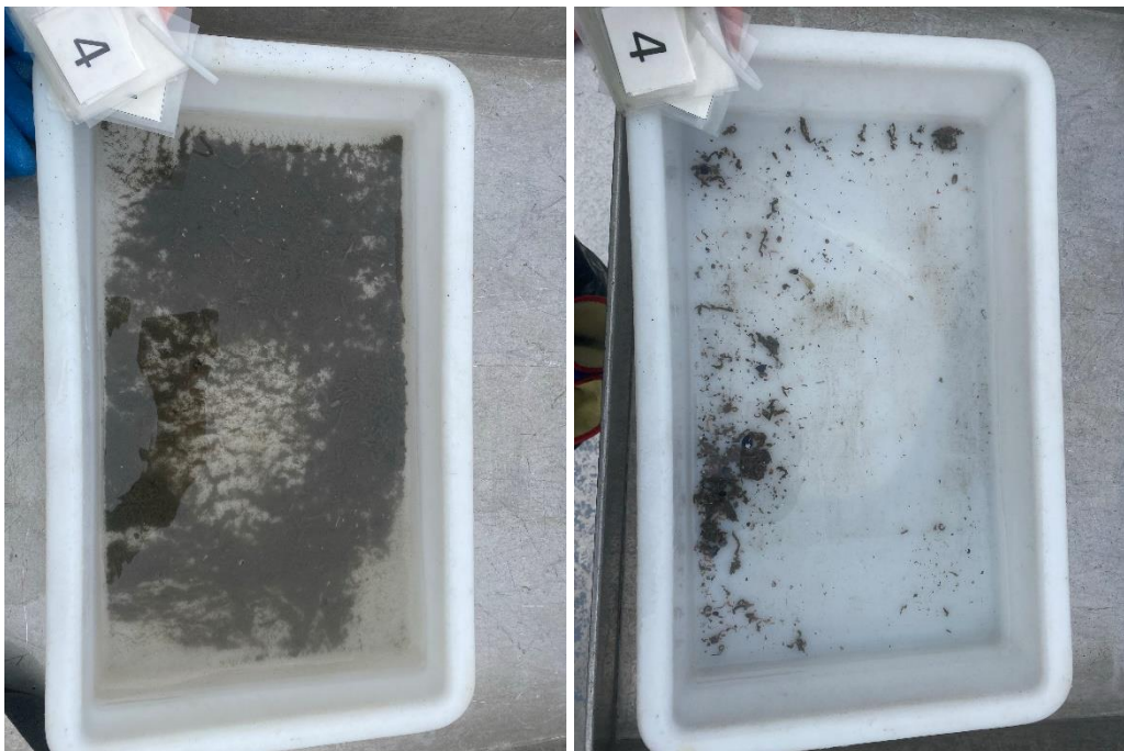
Figur 4: Bilder som viser sedimentet fra stasjon 4 før og etter siling. Sedimentet besto av silt. Foto: Aqua Kompetanse AS.
