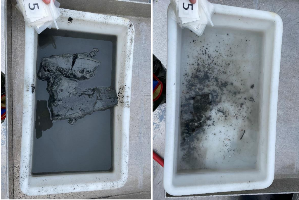
Figur 5: Bilder som viser sedimentet fra stasjon 5 før og etter siling. Sedimentet besto av leire og silt. Foto: Aqua Kompetanse AS.
