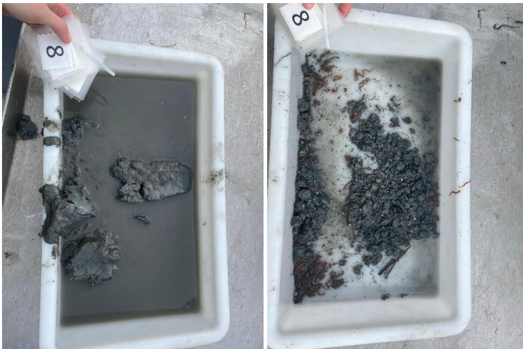
Figur 8: Bilder som viser sedimentet fra stasjon 8 før og etter siling. Sedimentet besto av leire. Foto: Aqua Kompetanse AS.
