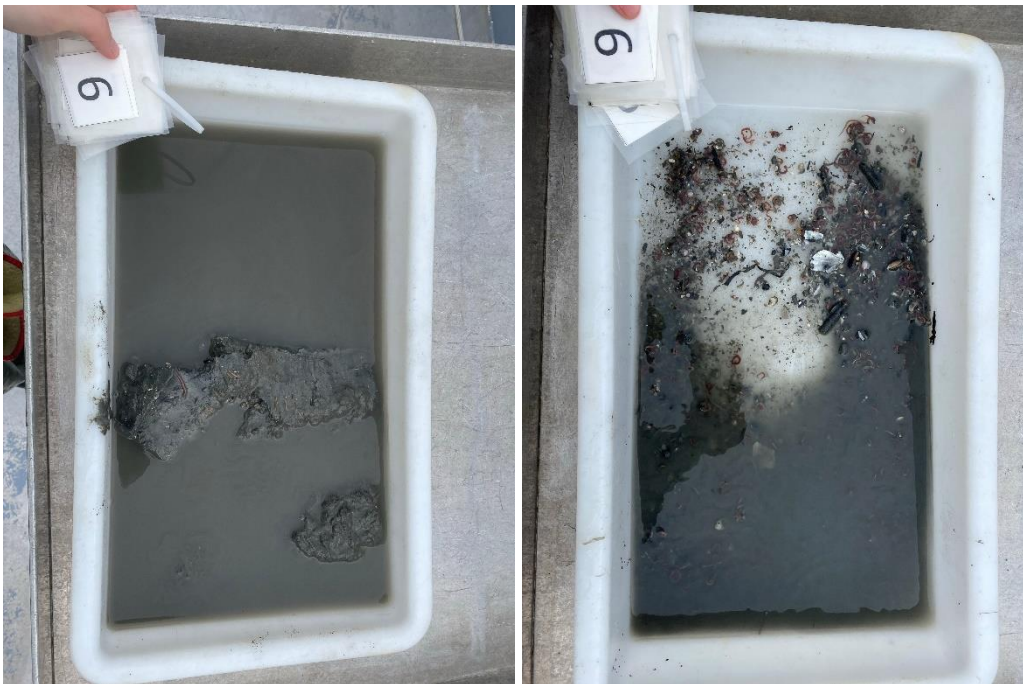
Figur 6: Bilder som viser sedimentet fra stasjon 6 før og etter siling. Sedimentet besto av silt og noe leire. Foto: Aqua Kompetanse AS.
