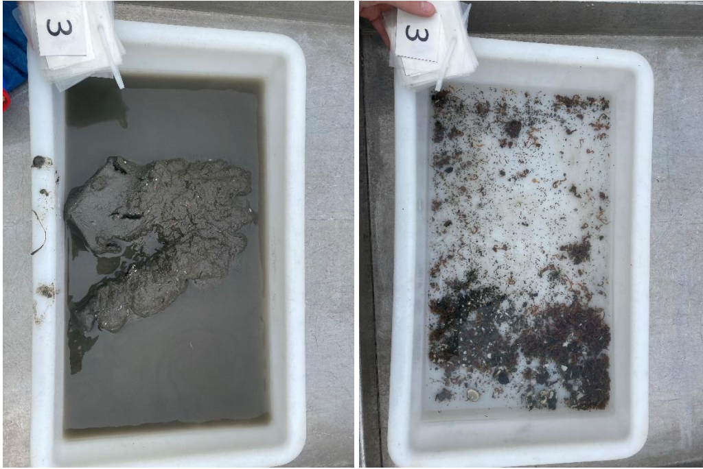
Figur 3: Bilder som viser sedimentet fra stasjon 3 før og etter siling. Sedimentet besto av silt og leire. Foto: Aqua Kompetanse AS.
