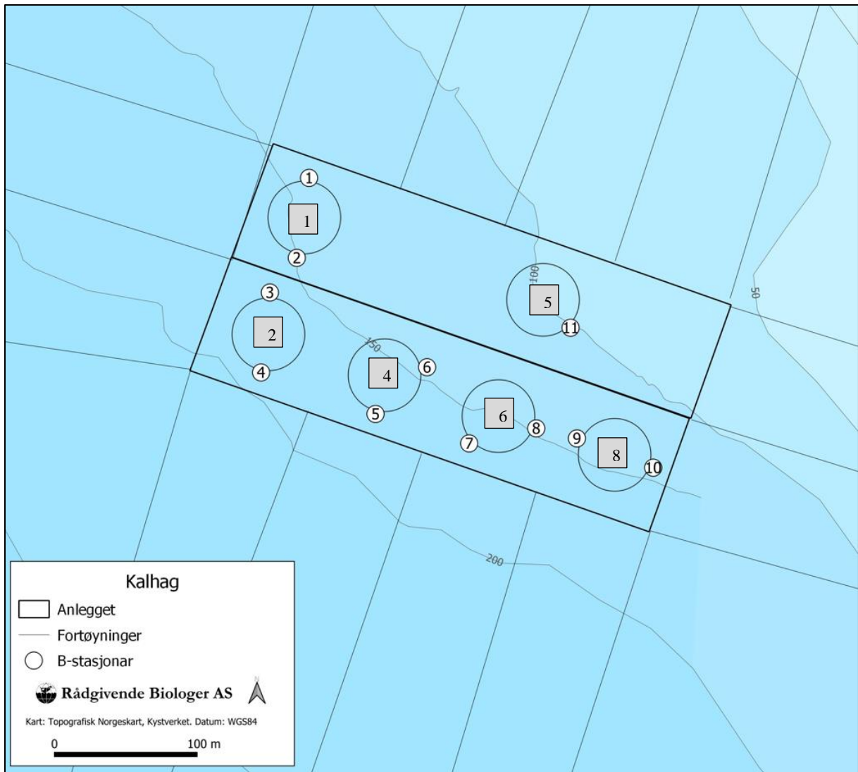
Figur 3. Oversikt over anlegget ved lokaliteten med merdnummer (grå firkantar) og plassering av grabbhugg (nummererte sirkclar).
