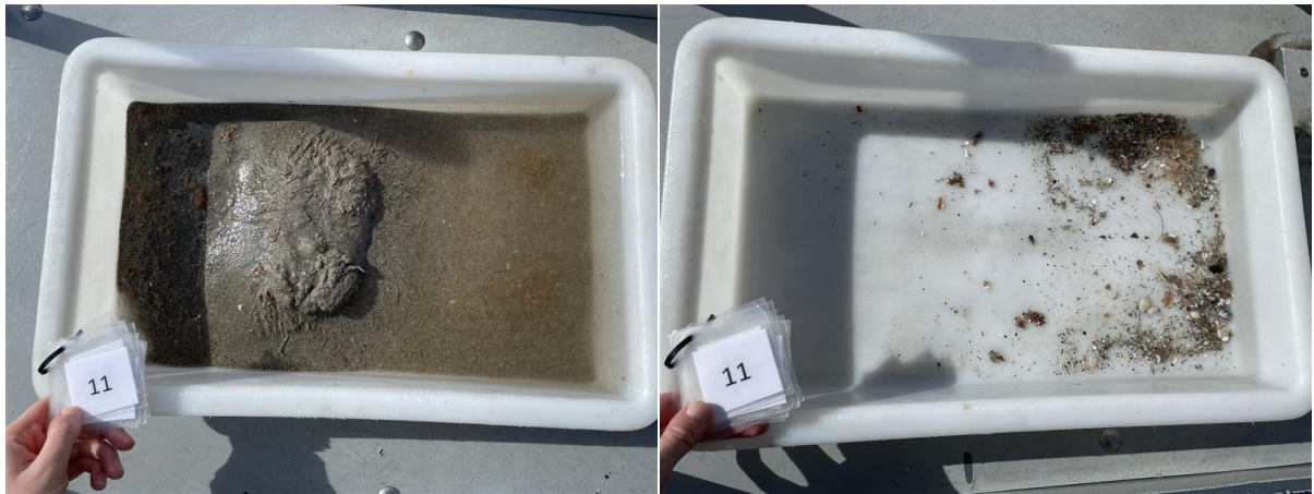
Figur 11: Bilder som viser sedimentet fra stasjon 11 før og etter siling. Sedimentet besto av silt og sand. Det ble registrert rester av fekalier ved stasjonen. Foto: Aqua Kompetanse AS.
