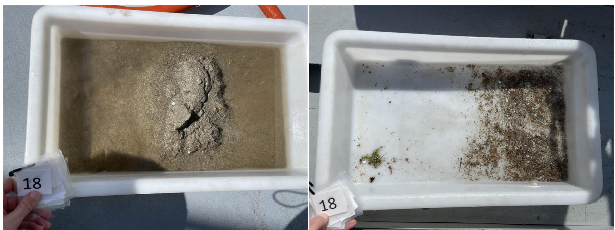
Figur 18: Bilder som viser sedimentet fra stasjon 18 før og etter siling. Sedimentet besto av silt og sand. Det ble registrert rester av fekalier ved stasjonen. Foto: Aqua Kompetanse AS.
