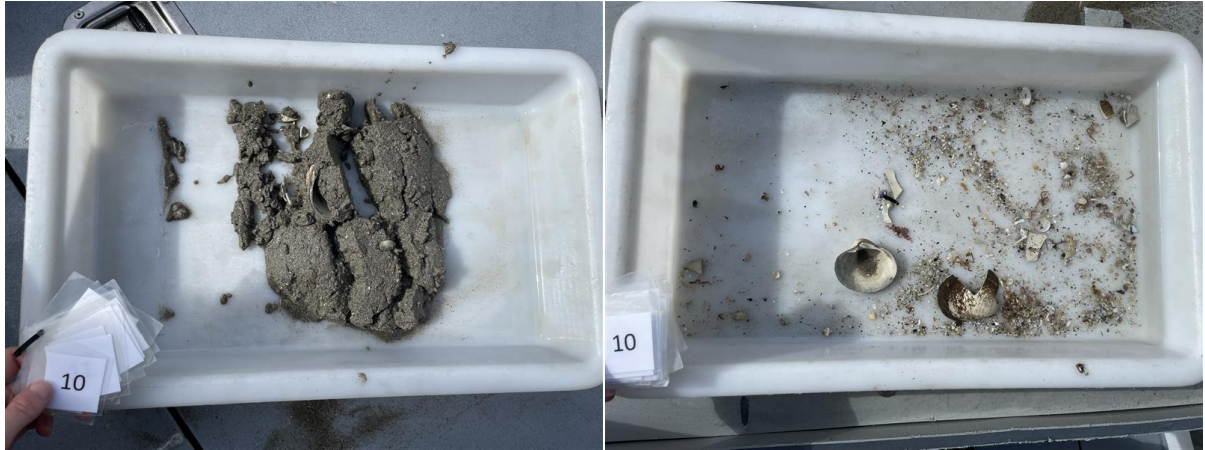
Figur 10: Bilder som viser sedimentet fra stasjon 10 før og etter siling. Sedimentet besto av silt og sand. Foto: Aqua Kompetanse AS.
