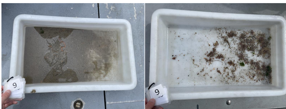
Figur 9: Bilder som viser sedimentet fra stasjon 9 før og etter siling. Sedimentet besto av silt og sand. Det ble registrert rester av fekalier ved stasjonen. Foto: Aqua Kompetanse AS.
