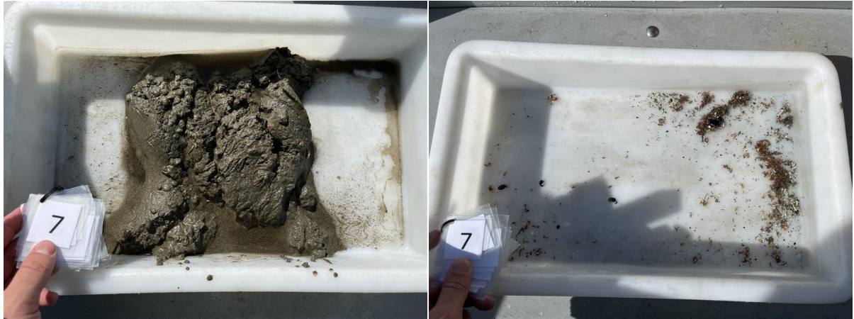
Figur 7: Bilder som viser sedimentet fra stasjon 7 før og etter siling. Sedimentet besto av sand og noe silt. Foto: Aqua Kompetanse AS.
