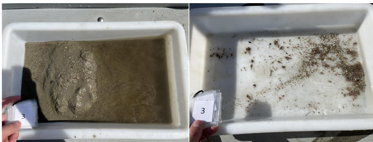
Figur 3: Bilder som viser sedimentet fra stasjon 3 før og etter siling. Sedimentet besto av sand og noe silt. Foto: Aqua Kompetanse AS.
