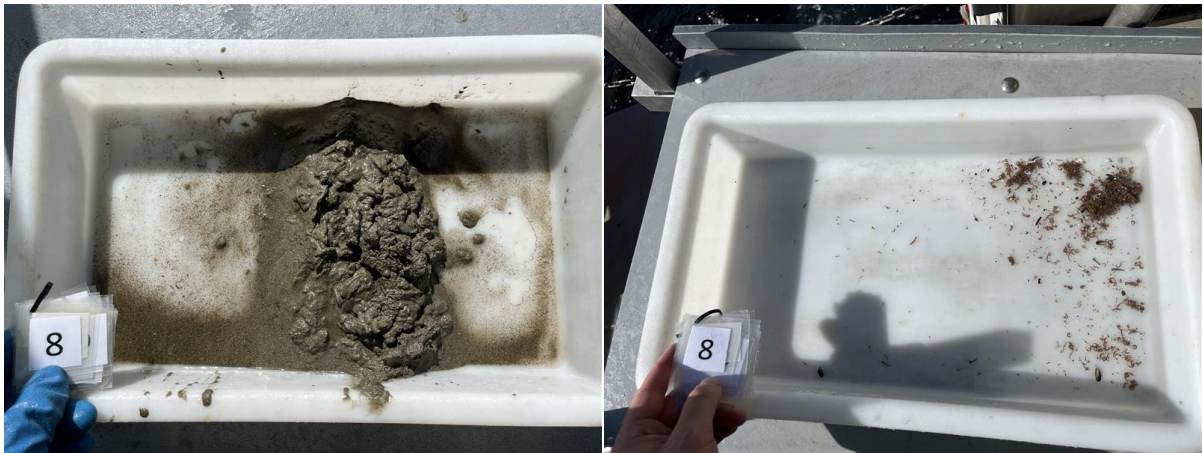
Figur 8: Bilder som viser sedimentet fra stasjon 8 før og etter siling. Sedimentet besto av sand og noe silt. Foto: Aqua Kompetanse AS.
