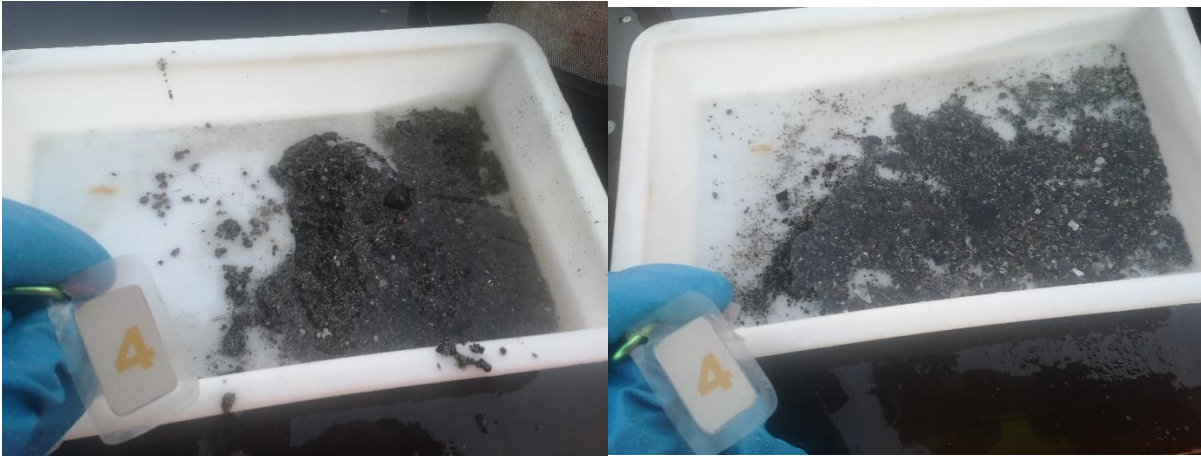
Figur 9: Bilder som viser sedimentet fra stasjon 4 før og etter siling. Sedimentet besto av sand og grus. Foto: Aqua Kompetanse AS.
