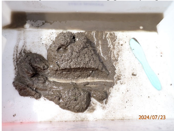
Prøvestasjon 7: Silt, sand og grus. Lys og luktfri prøve med fast konsistens.
