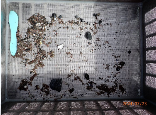
Prøvestasjon 7: Silt, sand og grus. Lys og luktfri prøve med fast konsistens.
