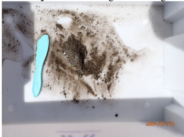
Prøvestasjon 10: Litt silt og sand. Grå og luktfri prøve med fast konsistens.
