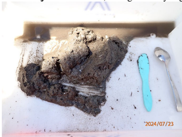
Prøvestasjon 9: Fast leire, silt og sand. Lys og luktfri prøve med fast konsistens.
