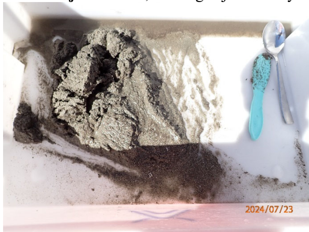
Prøvestasjon 12: Silt, sand og skjelsand. Lys og luktfri prøve med fast konsistens.
