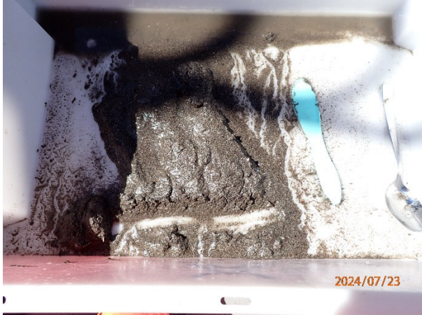
Prøvestasjon 13: Silt og sand. Grå og luktfri prøve med fast konsistens.
