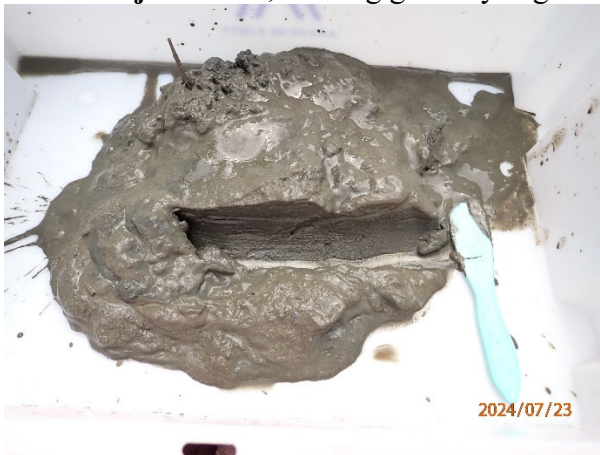
Prøvestasjon 8: Silt, sand og grus. Lys og luktfri prøve med fast konsistens.
