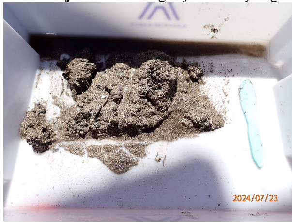
Prøvestasjon 14: Sand og skjelsand. Lys og luktfri prøve med fast konsistens.
