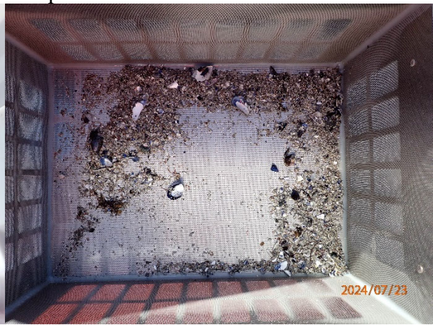
Prøvestasjon 14: Sand og skjelsand. Lys og luktfri prøve med fast konsistens.
