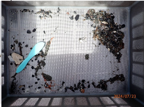
Prøvestasjon 8: Silt, sand og grus. Lys og luktfri prøve med fast konsistens.
