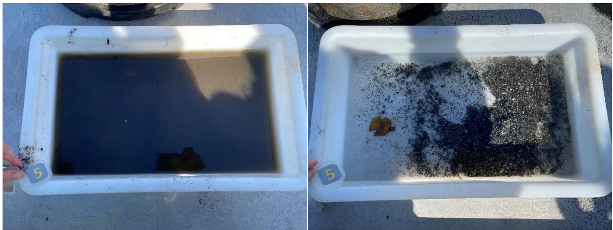
Figur 5: Bilder som viser sedimentet fra stasjon 5 før og etter siling. Sedimentet besto av sand, grus og skjellsand. Foto: Aqua Kompetanse AS.
