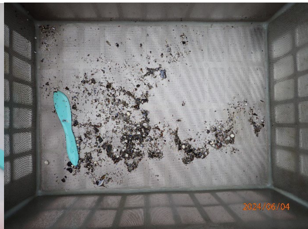
Prøvestasjon 6: Silt og sand. Lys og luktfri prøve med fast konsistens.
