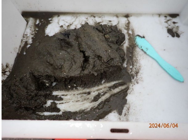
Prøvestasjon 7: Silt og sand. Lys og luktfri prøve med fast konsistens.
