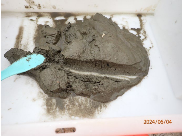
Prøvestasjon 4: Silt og sand. Lys og luktfri prøve med fast konsistens.
