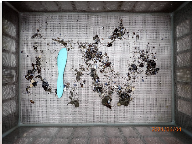
Prøvestasjon 5: Silt og sand. Lys og luktfri prøve med fast konsistens.
