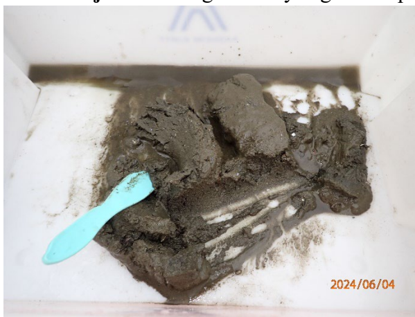
Prøvestasjon 5: Silt og sand. Lys og luktfri prøve med fast konsistens.
