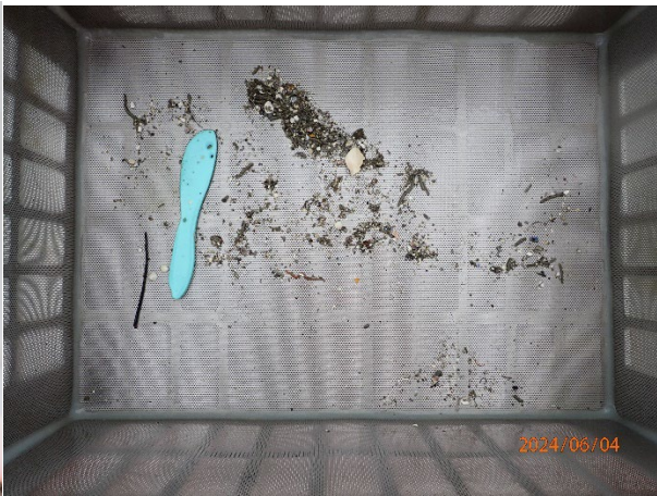
Prøvestasjon 4: Silt og sand. Lys og luktfri prøve med fast konsistens.
