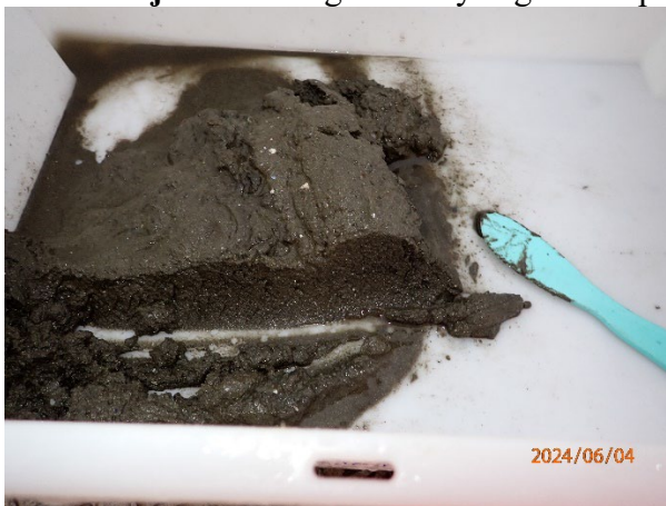
Prøvestasjon 6: Silt og sand. Lys og luktfri prøve med fast konsistens.
