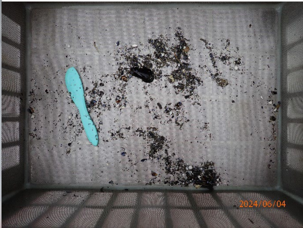
Prøvestasjon 7: Silt og sand. Lys og luktfri prøve med fast konsistens.
