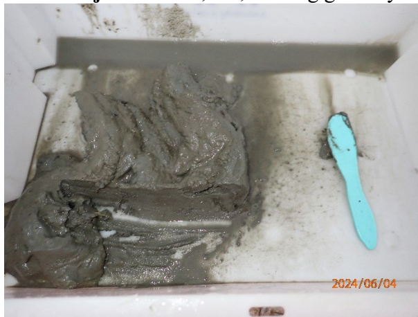
Prøvestasjon 8: Leire, silt, sand og grus. Lys og luktfri prøve med fast konsistens.
