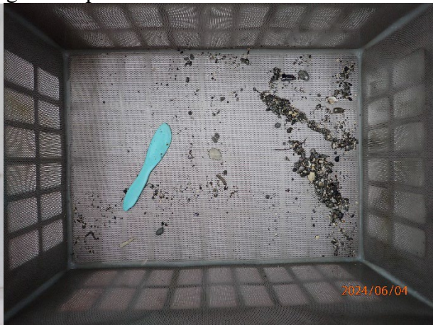
Prøvestasjon 8: Leire, silt, sand og grus. Lys og luktfri prøve med fast konsistens.
