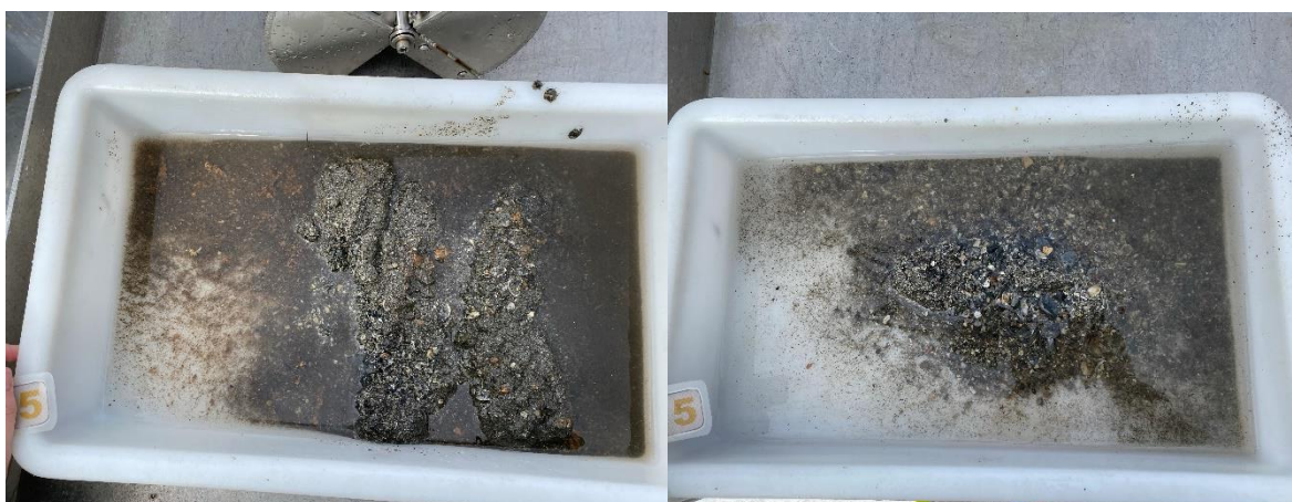
Figur 5: Bilder som viser sedimentet fra stasjon 5 før og etter siling. Sedimentet besto av sand og skjellsand. Det ble registrert fekalier ved stasjonen. Foto: Aqua Kompetanse AS.
