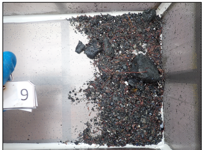
Figur 15. Bilde av sedimentet tatt opp ved prøvepunkt 9. Uvasket prøve til venstre og vasket/silt prøve til høyre.
