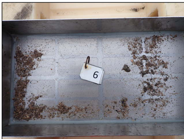
Figur 12. Bilde av sedimentet tatt opp ved prøvepunkt 6. Uvasket prøve til venstre og vasket/silt prøve til høyre.
