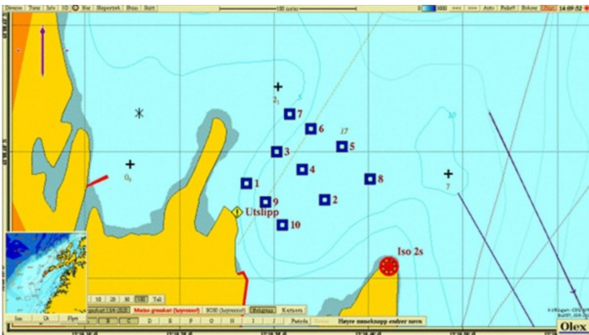
Figur 2. Batymetrisk kart (nordlig orientering) med avmerking av anleggsrammen og prøvestasjoner med tilstandsklasse: blå firkant; Tilstand 1, grønn firkant; Tilstand 2, gul firkant; Tilstand 3, rød firkant; Tilstand 4. Kartdatum WGS84.
