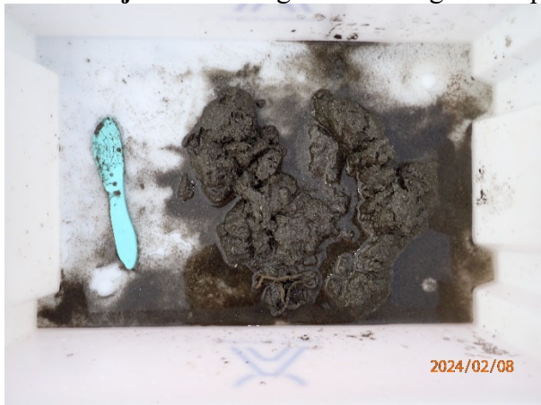
Prøvestasjon 12: Silt og sand. Grå og luktfri prøve med fast konsistens.
