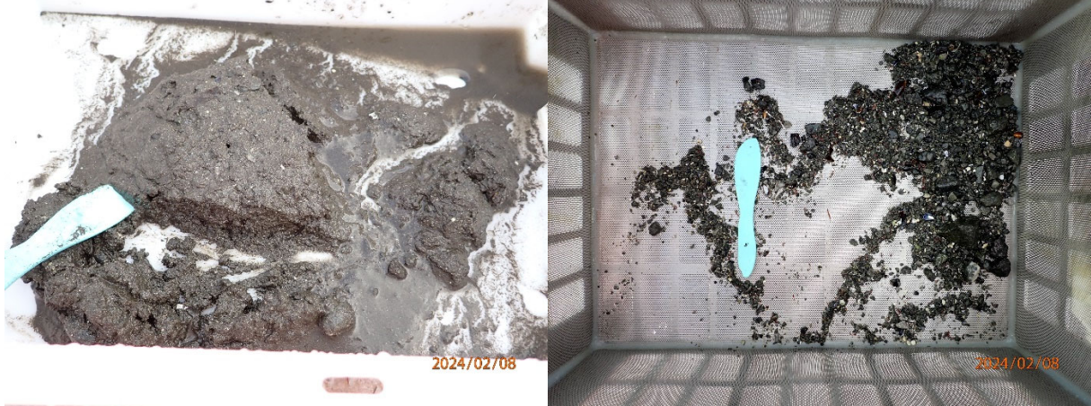
Prøvestasjon 7: Sand og grus. Lys og luktfri prøve med fast konsistens.
