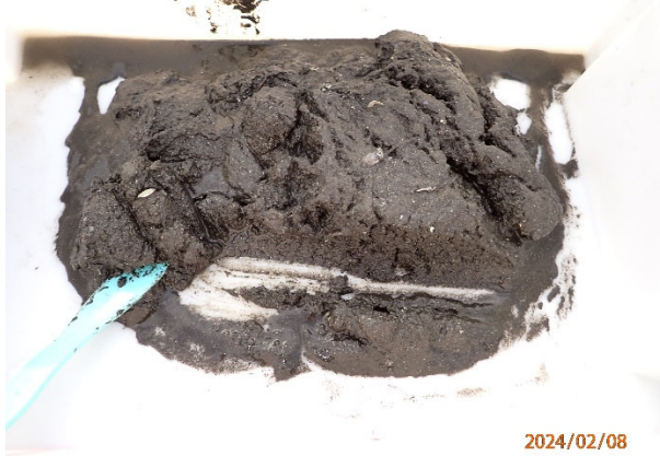
Prøvestasjon 10: Silt og skjelsand. Mørk farge og noko lukt i prøve med mjuk konsistens.
