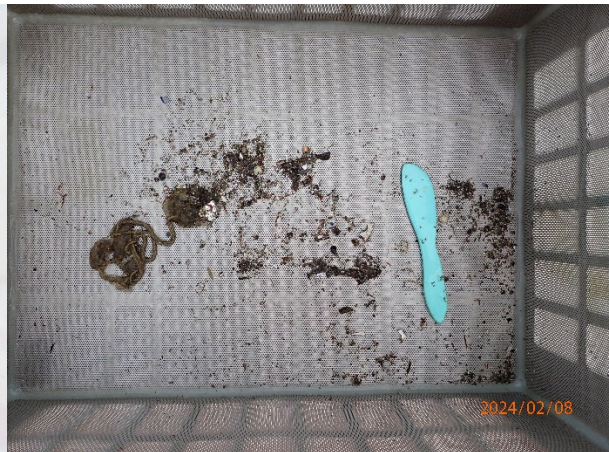
Prøvestasjon 12: Silt og sand. Grå og luktfri prøve med fast konsistens.
