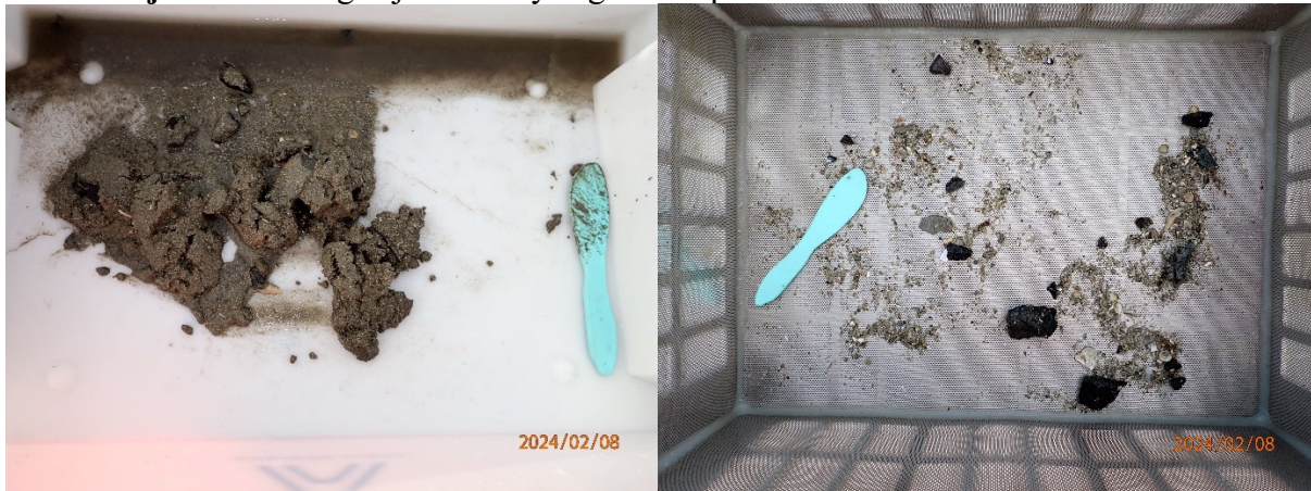
Prøvestasjon 9: Grus og skjelsand. Lys og luktfri prøve med fast konsistens.
