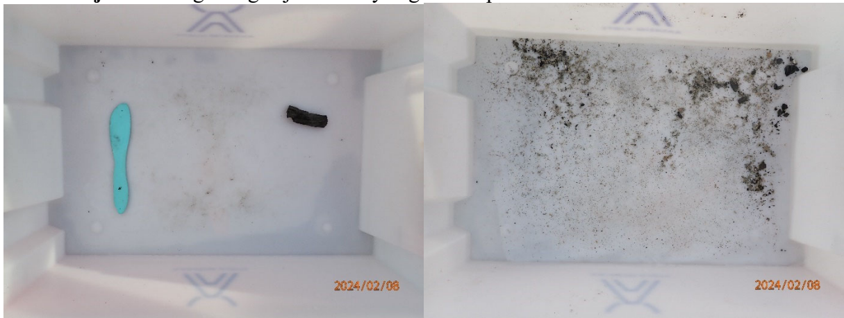
Prøvestasjon 9: Grus og skjelsand. Lys og luktfri prøve med fast konsistens.
