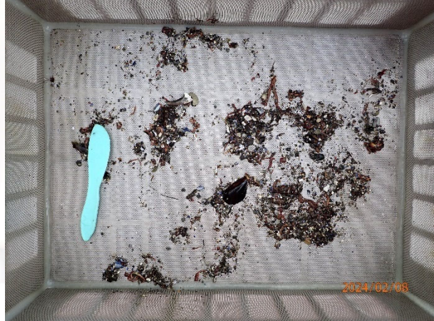
Prøvestasjon 10: Silt og skjelsand. Mørk farge og noko lukt i prøve med mjuk konsistens.
