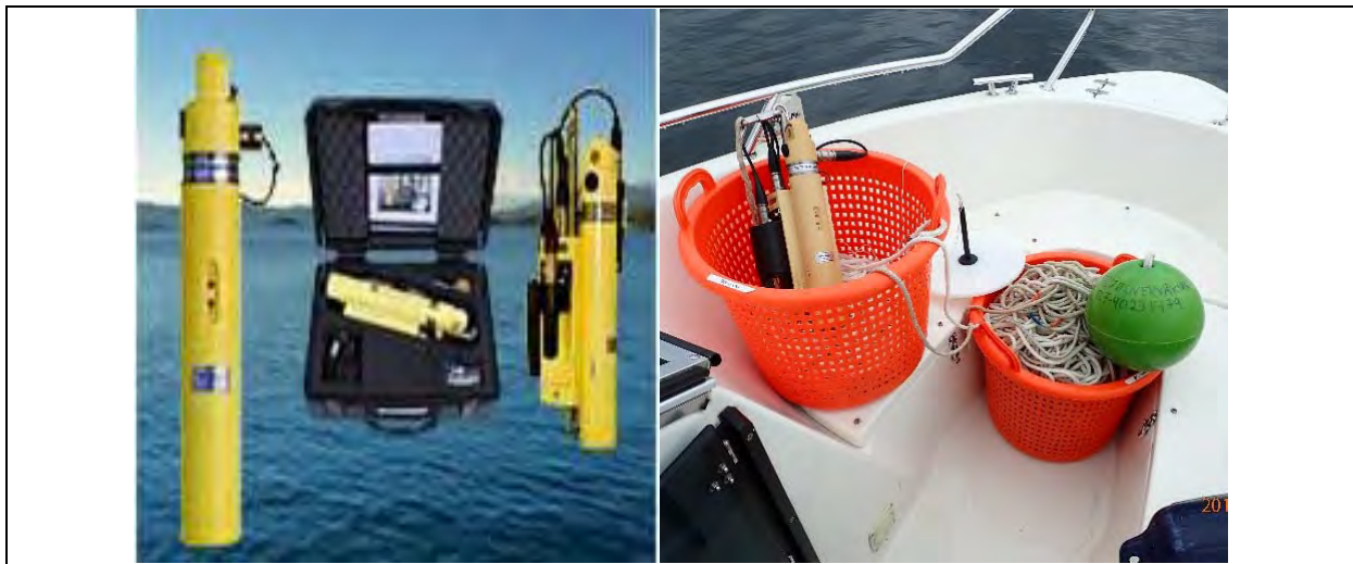
Figur 3.4 SD204 CTD-måler med klorofyll-sensor og ny optisk oksygen-sensor.
